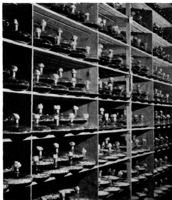
Abb. 2. Versuchsproduktion von Penicillin in Fernbachkolben (Ciba, Basel)
